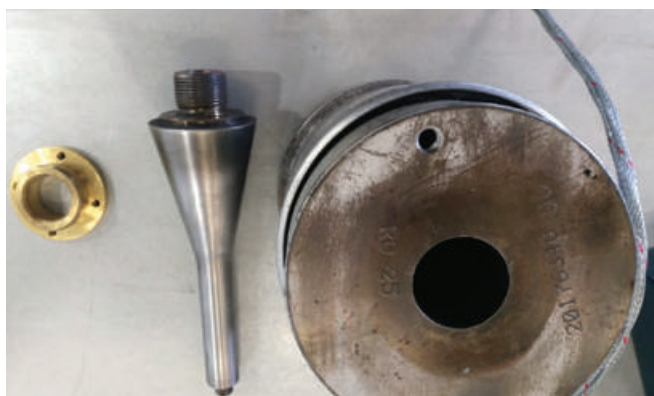
שיפור תהליך PEX - טבעת מרכז צינור 32 חסכון בזמן הפעלה 15-30 דקות חסכון בפחת של עשרות ק"ג בהפעלה התהליך החדש דורש פחות מיומנות בהפעלה
