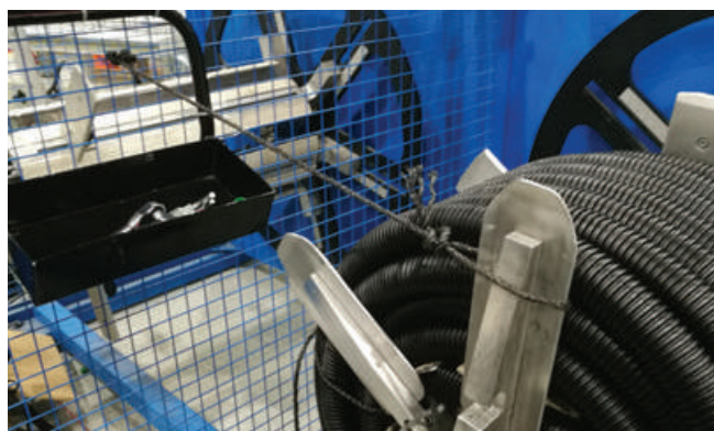
שיפור 2 שניות PEX - חבל מעצור למניעת השתחררות הצינור מהגליל בקשירה פשוט מאוד וחוסך כ-20 שניות בגליל 32 משורשר
