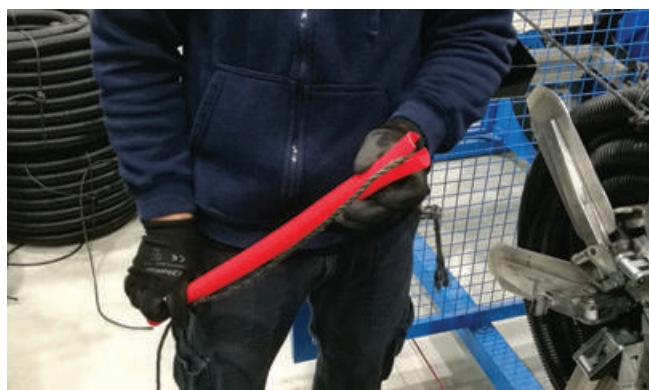
שיפור 2 שניות PEX - השחלת חבל לאריזת גליל, חסכון של כ-5 שניות בכל גליל
